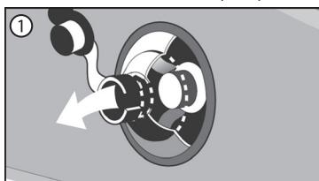
Um mit dem Aufpumpen zu beginnen, öffnen Sie die externe Verschlusskappe und ziehen Sie fest an der Schlaufe. Die Innendichtung wird dadurch geöffnet.
